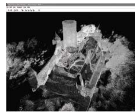
Die Nürburg wird zu einer 3D-Punktwolke, die maßlich exakt den Raumeindruck vermittelt und ...
